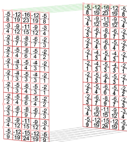
Rys.6 Wartości momentów zginających na kierunku x (momenty zginające poziomo) w ścianach pionowych przepustu
